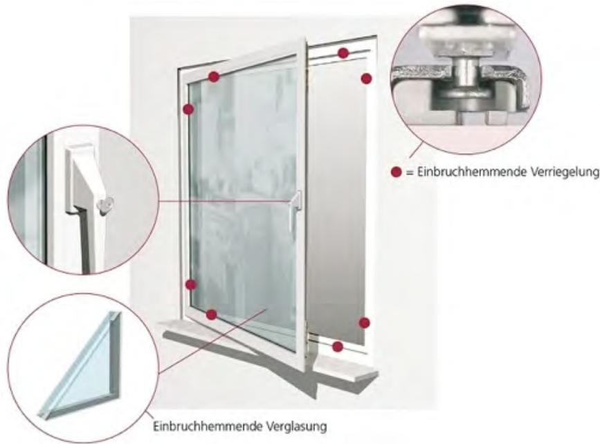
Abb. 4: Modell eines einbruchhemmenden Fensters<sup>19</sup>
